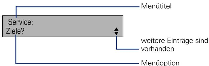
Die Menüstruktur umfasst mehrere Ebenen. Innerhalb dieser Struktur zeigt die erste Zeile das gerade gewählte Menü und die zweite Zeile eine Option dieses Menüs.
